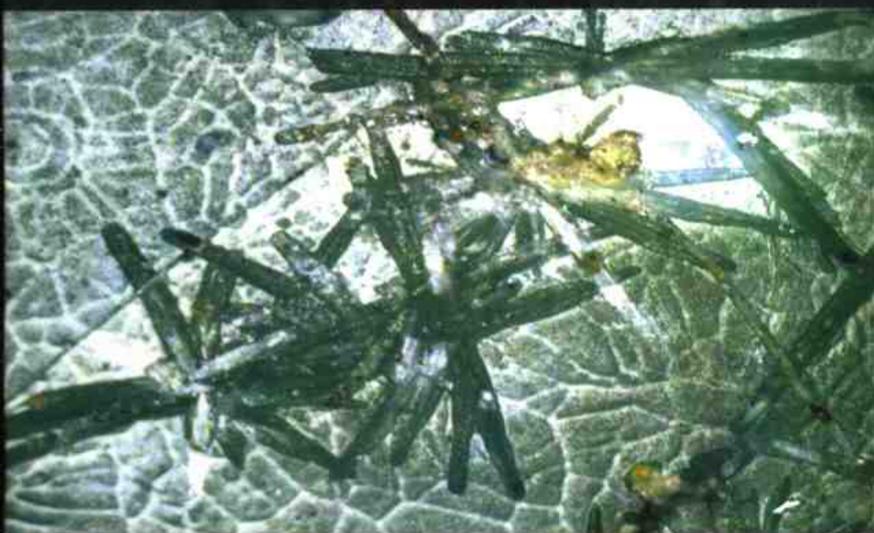
唐代邢窑瓷釉的显微结构
